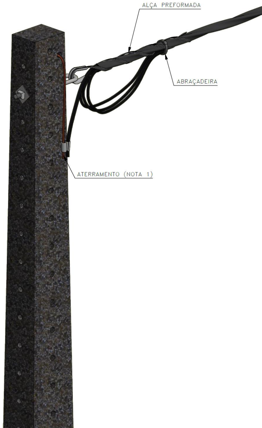
ESTRUTURA DE ANCORAGEM
